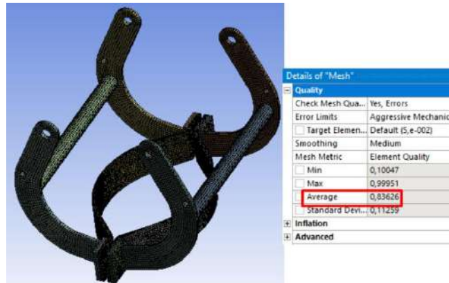
Figura 23. Mallado de calidad de las tenazas
