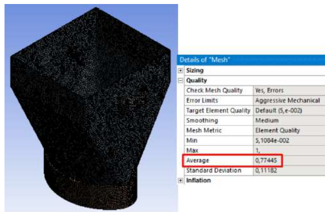
Figura 30. Mallado de calidad de la tolva
