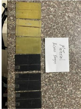
Figura 11. Comparación de desempeño entre imprimaciones en función del tipo de metal y tipo de ensayo
