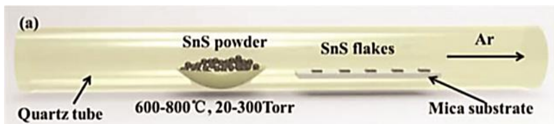
Figura 5. Esquematización PVD para el crecimiento de cristales.
