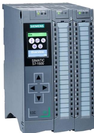
**Nota:** En la imagen el componente de la izquierda es la CPU del PLC SIMATIC S7 1500; el componente del centro es el módulo de entrada analógico y el componente de la derecha es el módulo de entrada/salida digital (Siemens, 2013)
