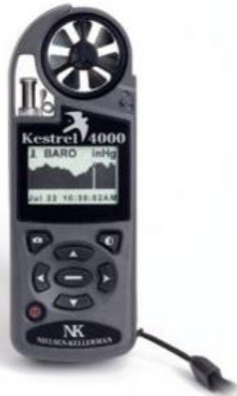
Figura 4. Anemómetro Kestrel 4000. Fuente: (Pascual Garcia-Nuñez, 2016)
