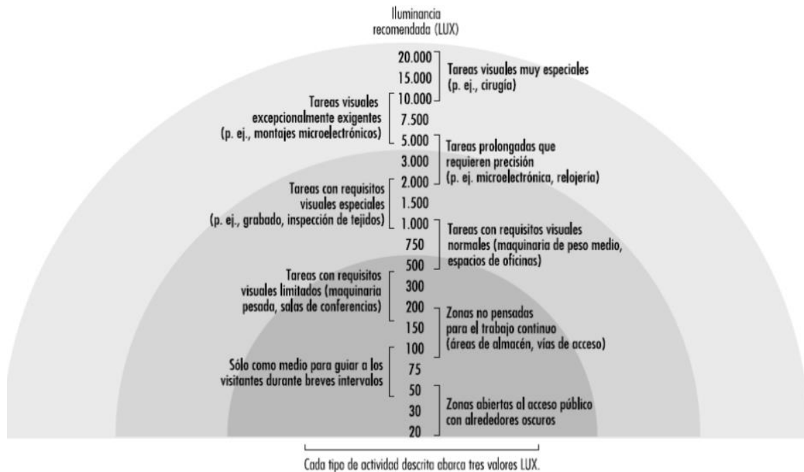
Figura 3. Niveles de iluminación en función a las tareas a realizar. Fuente: (Pascual Garcia-Nuñez, 2016)
