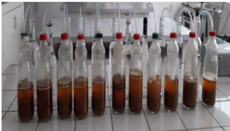
Figura 1: Sistema de maceración fermentativa, muestra los 11 tratamientos del DCCR con combinaciones de azúcares y nutriente enológico V ACTIV
