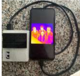
Figura 1: Cámara termográfica fabricada por estudiantes de la Universidad Internacional Del Ecuador.
