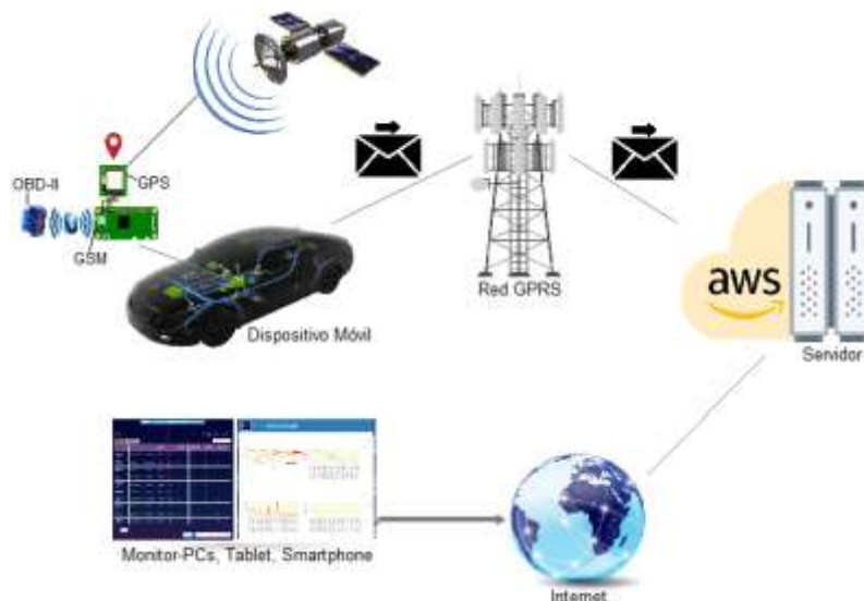
Figura 7: Arquitectura del sistema de adquisición y visualización de datos
