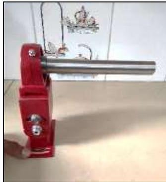
El eje de pruebas se diseñó con el fin de simular desviaciones de manera vertical y horizontal para ver si los sensores son capaces de detectar las desviaciones, moviendo unos pernos que se colocaron en el eje de pruebas.
