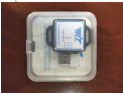
El voltaje de trabajo es de 3.3V-5V, incorpora una batería de 250mAh, que puede durar unas 10 horas de trabajo. La aceleración mide hasta  $\pm 16g$ , la velocidad angular  $\pm 2000^\circ / s$  y los ángulos:  $X Z \pm 180^\circ$ ,  $Y \pm 90^\circ$ .
