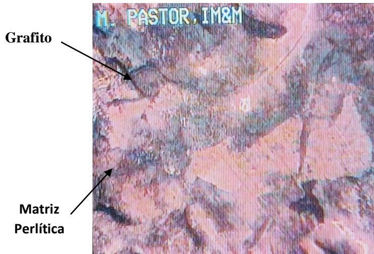
Figura 11. Fotomicrografía de la estructura de Hierro Fundido Gris del área transversal de la probeta tomada a 444x, atacada químicamente con nital al 2% durante cinco segundos; zona negra (hojuelas de grafito), zona gris (matriz perlítica).
