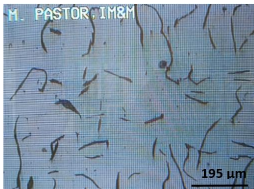
Figura 9. Fotomicrografía de la estructura de Hierro Fundido Gris del área transversal de la probeta tomada a 110x (sin ataque químico), zona negra (hojuelas de grafito). Fuente: Elaboración propia.
