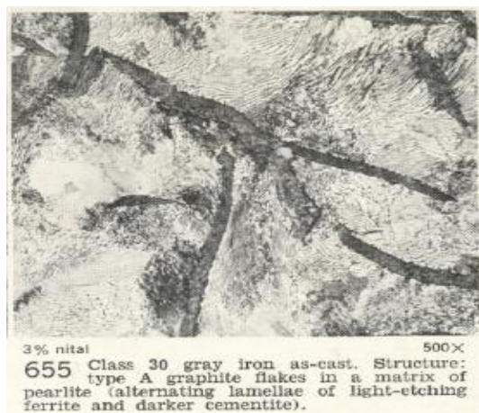
Figura 12. Fundición de hierro gris clase 30. Estructura tipo A Escamas de grafito en una matriz de perlita (láminas alternas de ferrita de grabado claro y cementita más oscura), a 500x.
