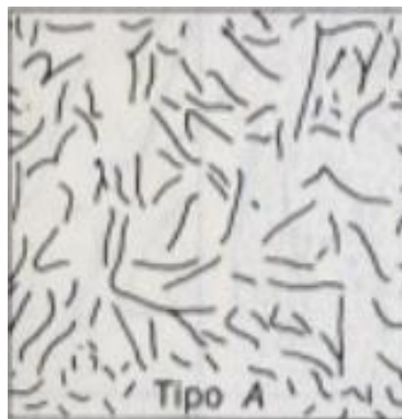
Figura 18. Tipo de hojuelas de Grafito de la probeta ensayada. Fuente: Introducción a la Metalurgia Física AVNER.
