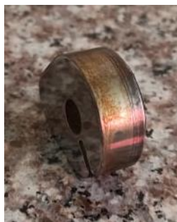
Figura 8. Área Transversal del árbol de levas, después del desbaste para la observación de la microestructura. Fuente: Elaboración propia.
