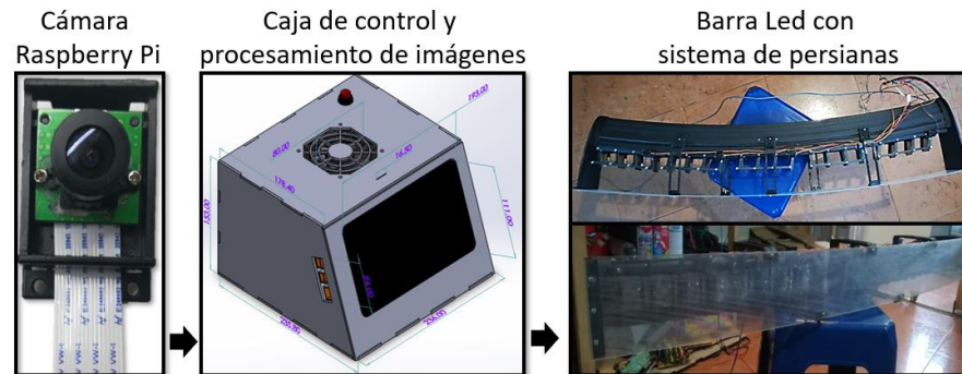
Figura 1: Sistema prototipo de luces frontales con segmentación para automotores. Realizado por: Coyago, Jhinson & Coyago, Jonathan. 2019
