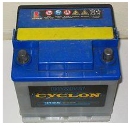
Figura 1: Batería de ácido-plomo de vehículo convencional. Fuente: (Zyga, 2021)
