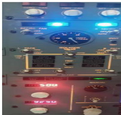
Figura. 15. Sistema de presurización y aire acondicionado
