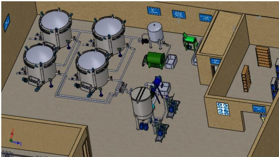
**Figura 5.** Diseño 3D de la planta de producción de biofertilizante
