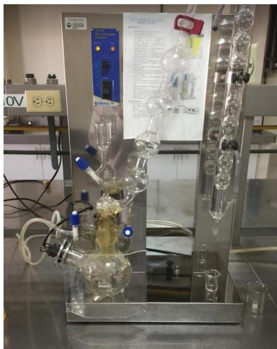
**Figura 1.** Equipo de fermentación alcohólica.
