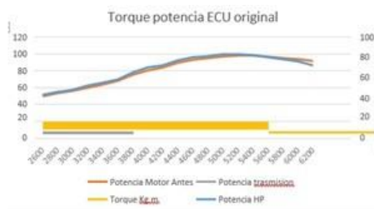
Figura 8. Torque y potencia antes de la implementación de la ECU programable.
