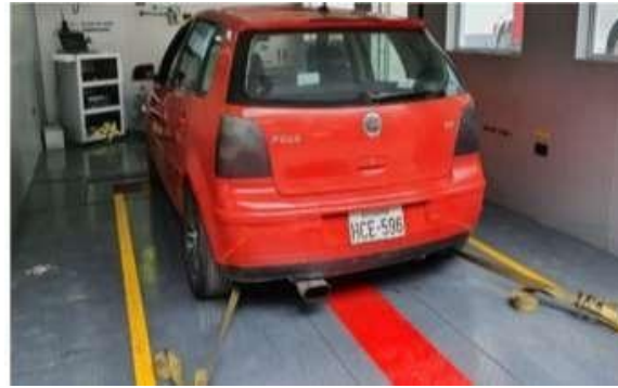
Figura 2. Vehículo prueba sobre rodillo dinamométrico.
