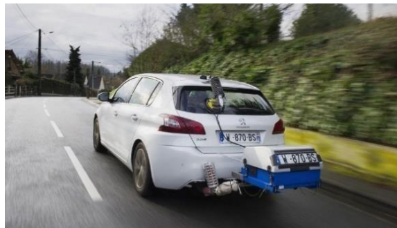
Figura 1. Representación de la prueba de análisis de gases dinámica a bordo.
