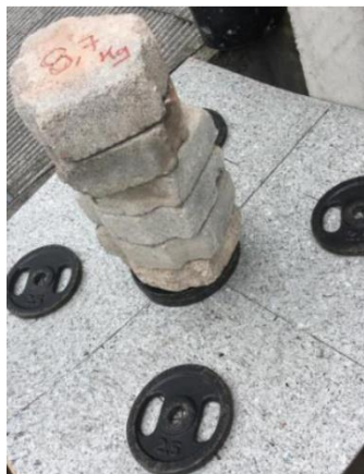
Figura 5: Distribución de la carga de 20kg en las láminas de Tetra Pak
