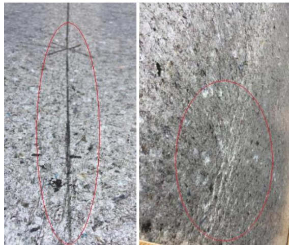
Figura 9: Fallas de las láminas de Tetra Pak
