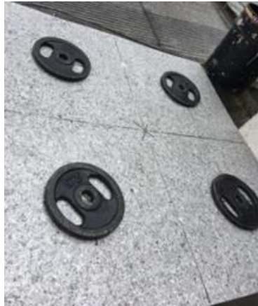
Figura 3: Distribución de la carga de 10kg en las láminas de Tetra Pak
