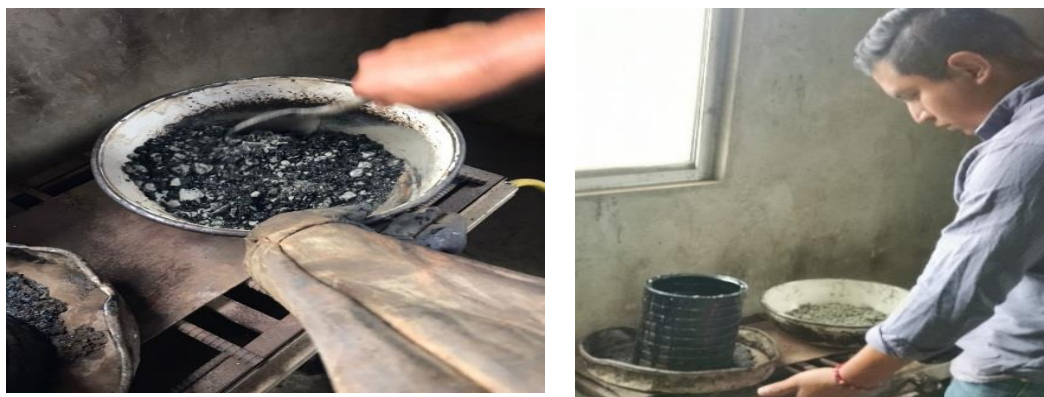
Figura 5: Contenedores de aluminio para calentado en horno de muestras de 1500 g de cemento asfáltico (izq.). Calentamientos de cemento asfáltico (der).
