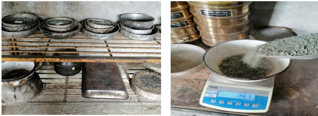
Figura 4: Separación de áridos según tamaño, luego de tamizado, para reconstitución granulométrica. (Der.) Pesaje de las fracciones de árido para formar muestras de 1500 g de árido en granulometría semidensa e incorporación de zeolita.
