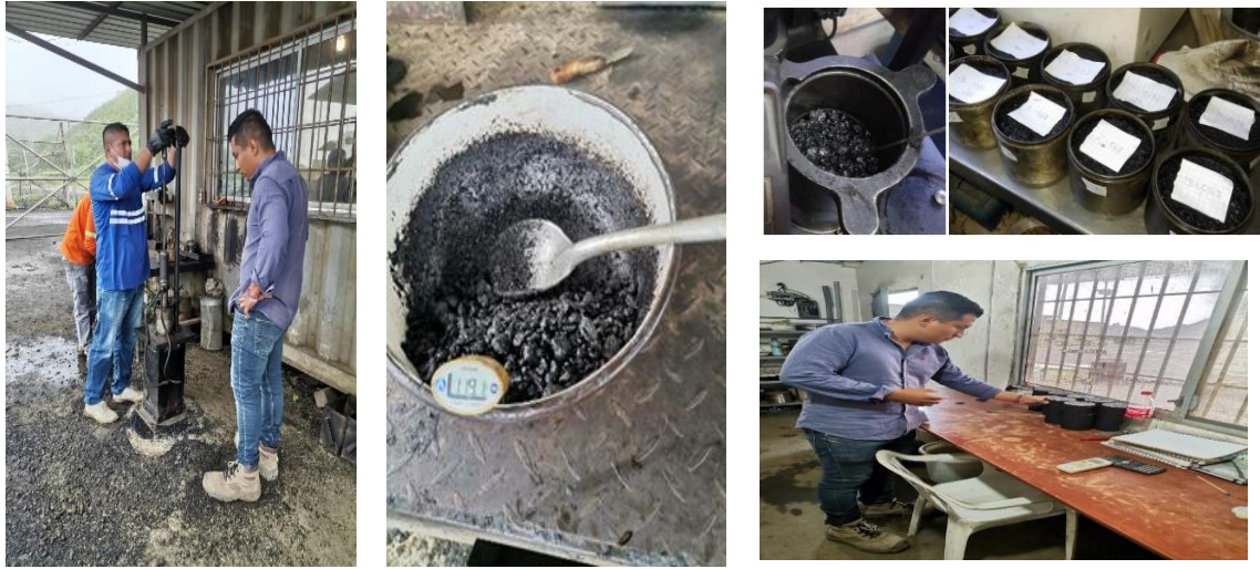
Figura 6: Mezcla asfáltica directo a compactación a temperatura de 120 ° C.
