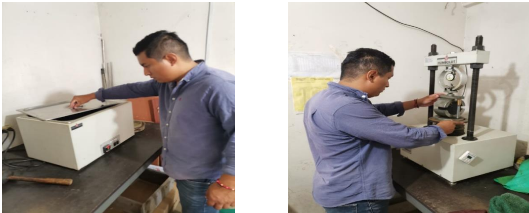
Figura 7: Mezcla asfáltica directo a compactación a temperatura de 120 ° C.
