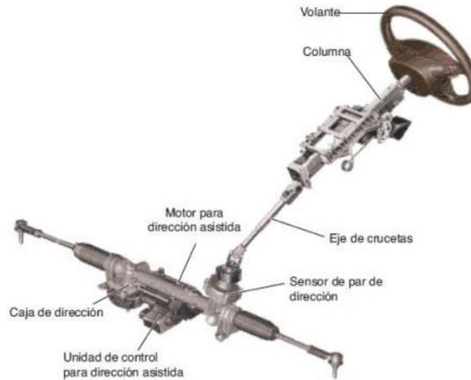
Figura 10: Sistema de dirección eléctrica
