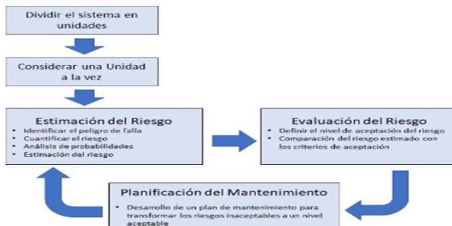
Figura 2: Plan de mantenimiento anticorrosivo basado en los riesgos
