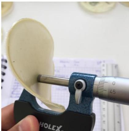
**Figura 8:** Medición del espesor de las muestras
