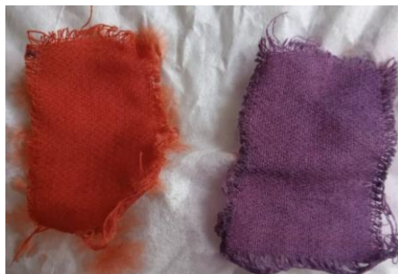
Figura 3. Prueba de teñido usando ácido carmínico en cristales y el carmín
