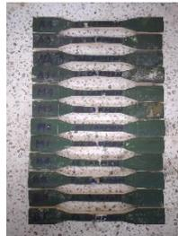
*Fig. 6 y 7. Ejemplo de probeta para ensayo de tensión.*
