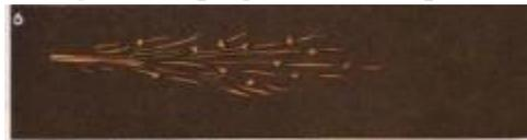
**Fig2.** Chispa generada por el esmerilado del tipo 6 (Bosco, n.d.)
