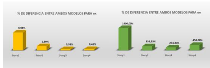
Figura 11: Porcentajes de diferencia de excentricidades entre ambos modelos para sismo estático y dinámico en los ejes X e Y.
