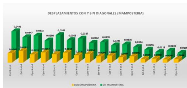
Figura 8: Desplazamientos con y sin diagonales (mampostería).
