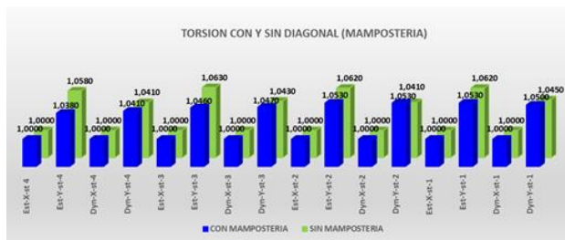
Figura 14: Torsión con y sin diagonales (mampostería).
