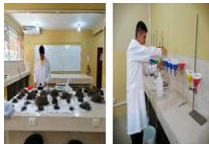
Figura 4. Desarrollo de la técnica embudo de Baermann para la extracción de nematodos.
