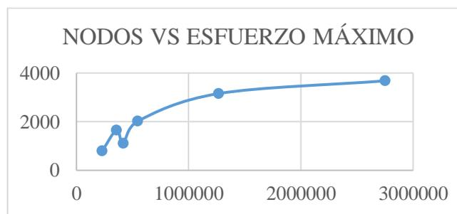
Figura 13. Gráfica de convergencia en esfuerzo máximo
